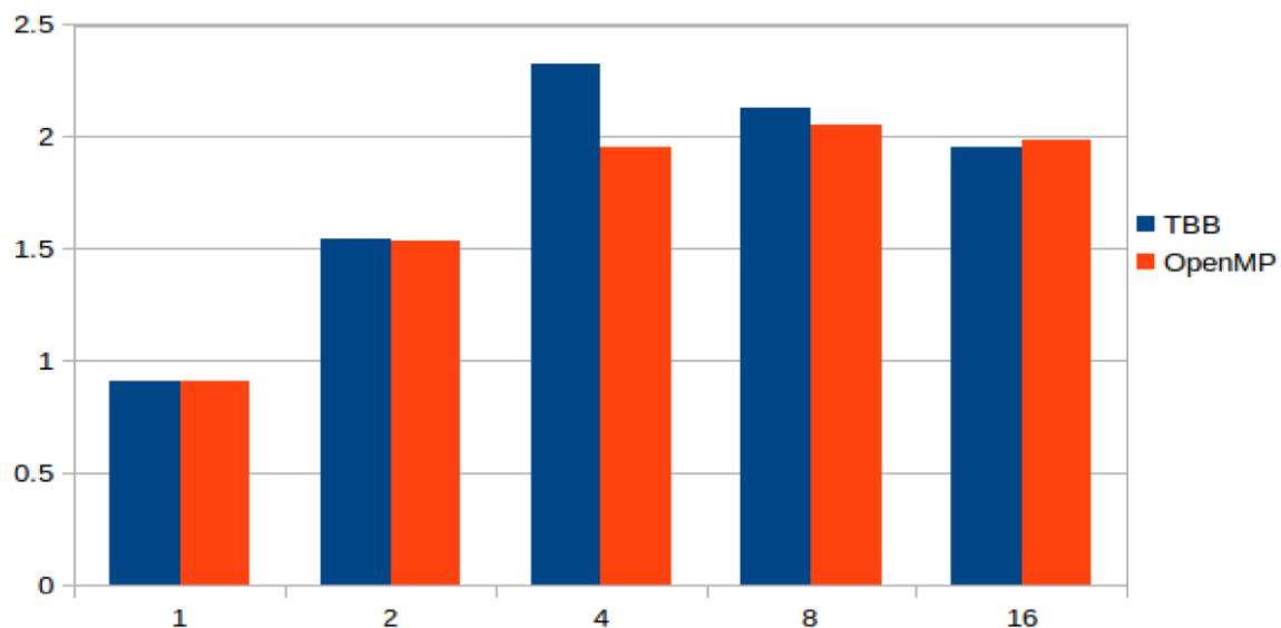
Figura 1. Speedup das versões em TBB e OpenMP
