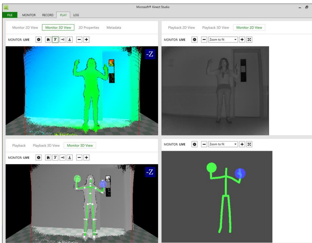
Figura 2 - Mapeamento do corpo com as visões de Color, Infrared, Body, e BodyIndex no Microsoft Kinect Studio™
